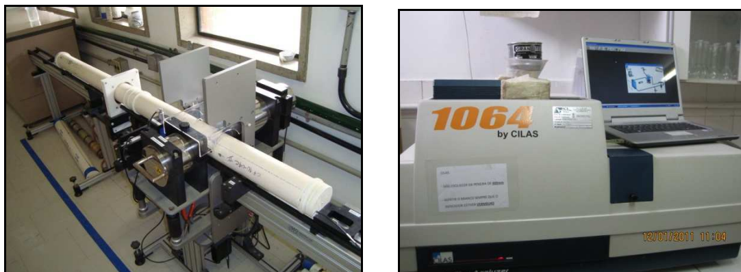
Foto 2 Perfilador de testemunhos MSCL da Geotek (esquerda) e Analisador de Difração a laser CILAS 1064 (direita).
