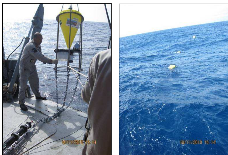
Figura 54 Lançamento de uma das armadilhas de sedimento e um CTD e visualização da linha na água para lançamento da poita principal.
