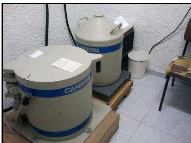
Foto 4 Detector semi-planar de germânio de alta-pureza no Laboratório de Radioisótopos do Departamento de Geoquímica da UFF.
